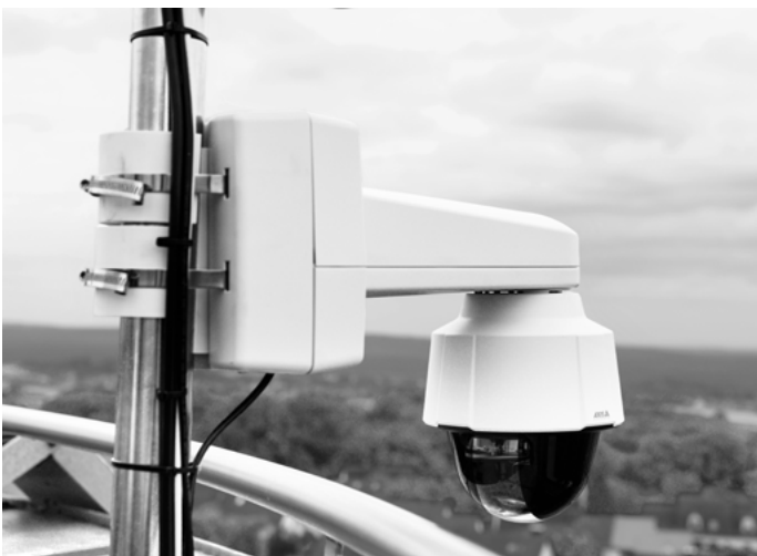
Das kamerabasierte System wertet Bilddaten mithilfe künstlicher Intelligenz aus und erkennt Rauchentwicklungen zuverlässig und frühzeitig.
