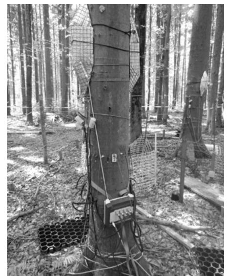
Ein Messbaum: Alufolie isoliert die darunterliegenden Saftflusssensoren. Das Dendrometer (braunes Band) kontrolliert, wie viel der Baum wächst, und die an Nägeln befestigten Elektroden stellen die Wasserverteilung im Baum bildlich dar. Quelle: Uni Innsbruck/Beikircher
