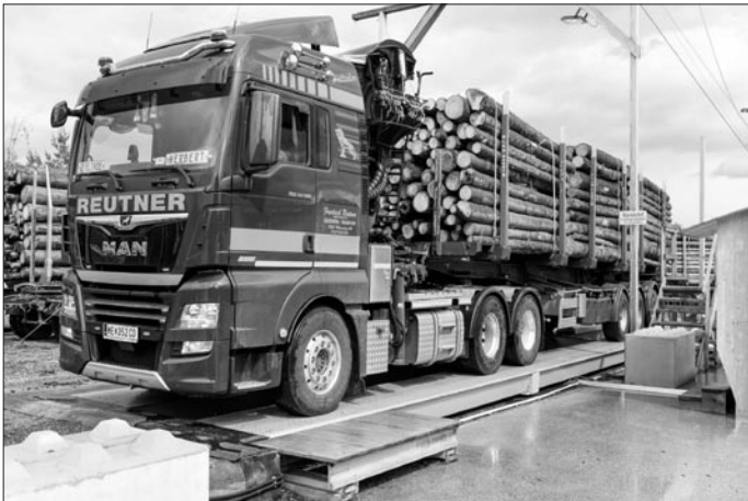
Mobile Brückenwaage - vollautomatische Verwiegung des Ladegutes.
